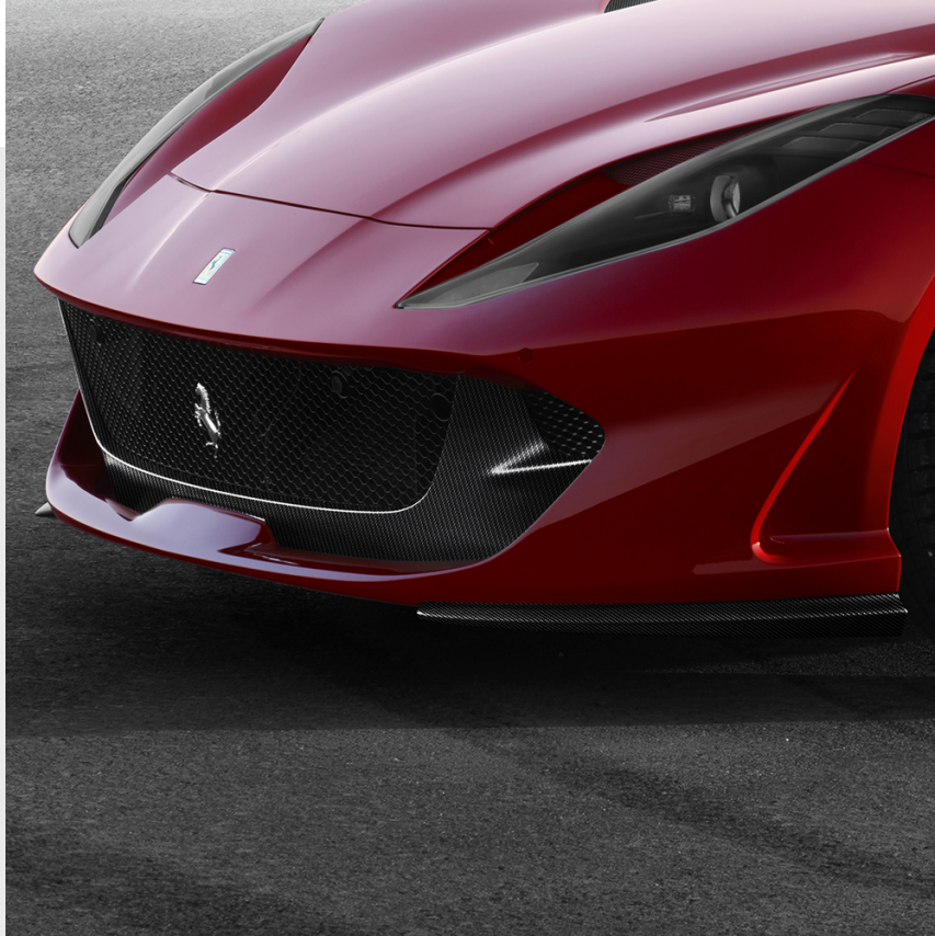
Spoiler delantero de fibra de carbono, boca paragolpes
