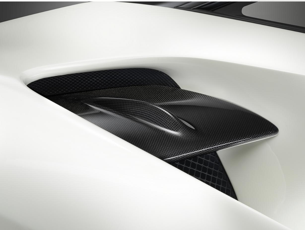
Los divisores instalados en las tomas de aire laterales son elementos icónicos que caracterizan las líneas deportivas del automóvil, además de separar los flujos de aire para garantizar el máximo rendimiento del motor.
