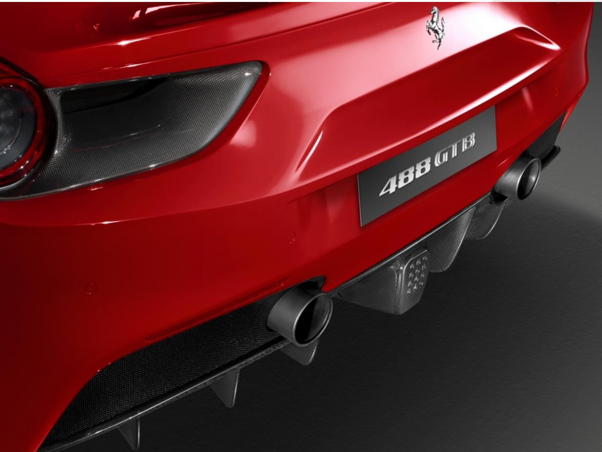
Los colines de escape de acero con revestimiento cerámico se caracterizan por el uso de materiales avanzados y tratamientos superficiales específicos, y dan al vehículo un aspecto más brioso y deportivo. El revestimiento cerámico permite dispersar grandes cantidades de calor, resistir posibles daños accidentales y, gracias a la tecnología específica empleada, mantener la estética sin cambios a lo largo del tiempo.
