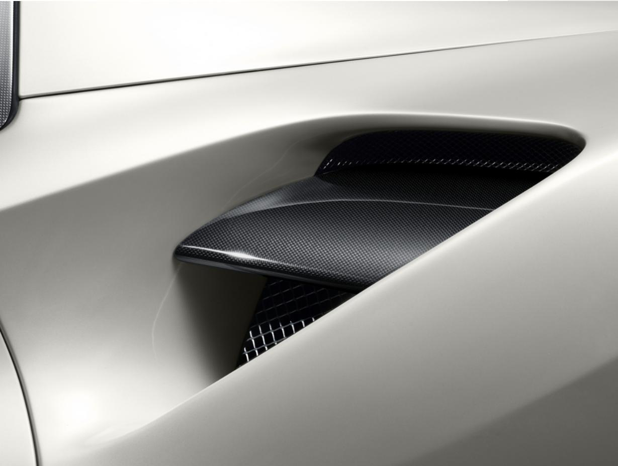
Para destacar elementos icónicos como los splitters de las tomas de aire laterales utilizados para dividir los flujos de aire y garantizar el máximo rendimiento del motor, Ferrari Genuine ofrece la variante de fibra de carbono. Esta solución contribuye a reducir el peso total y a resaltar la deportividad del vehículo, dándole un aspecto brioso y muy característico.
