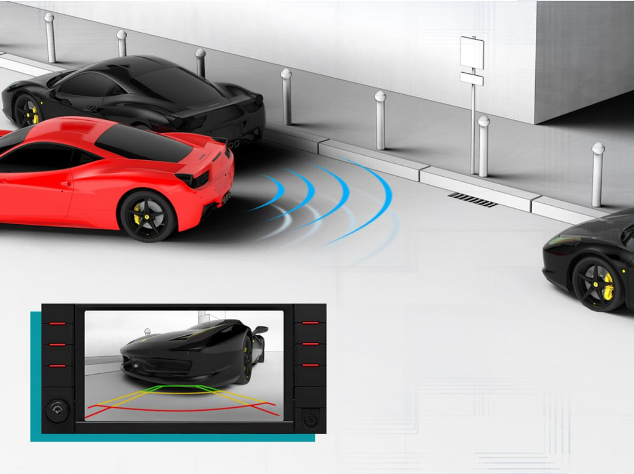
El sistema de cámara de aparcamiento ofrecido por Ferrari permite evitar impactos accidentales durante las fases de aparcamiento. Los kits, que incluyen las cámaras delanteras y traseras, muestran en el cuadro de instrumentos la información necesaria y, gracias a la integración de los sensores de aparcamiento y a una cómoda rejilla virtual, ayudan al conductor durante las maniobras
