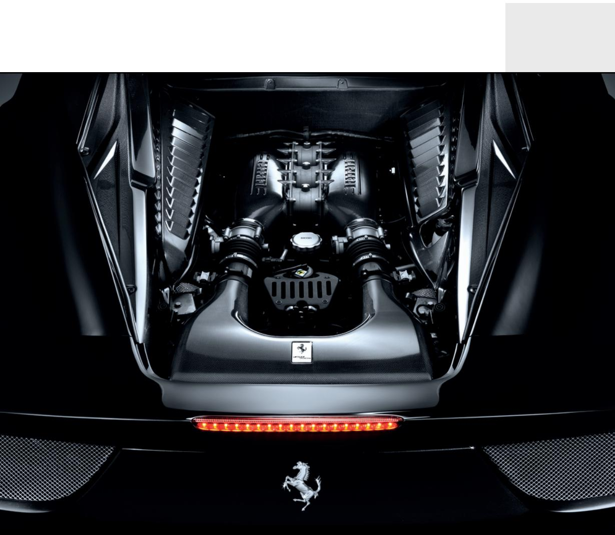
Las mamparas del vano motor de fibra de carbono permiten reducir el peso con respecto a las piezas de serie: la fibra de carbono es de hecho un material ultraligero, resistente al calor, que permanece inalterable en el tiempo gracias a las cualidades técnicas y estéticas del componente y a la capa protectora transparente con la que está recubierto.
