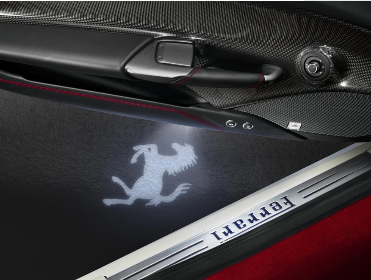
La iluminación bajo la puerta permite añadir a su Ferrari un componente adicional de estilo único: El kit está compuesto por dos plafones y cuatro series de lentes especiales que proyectan el logotipo del vehículo o el Cavallino Rampante directamente sobre el suelo, en la zona de apertura de las puertas.
