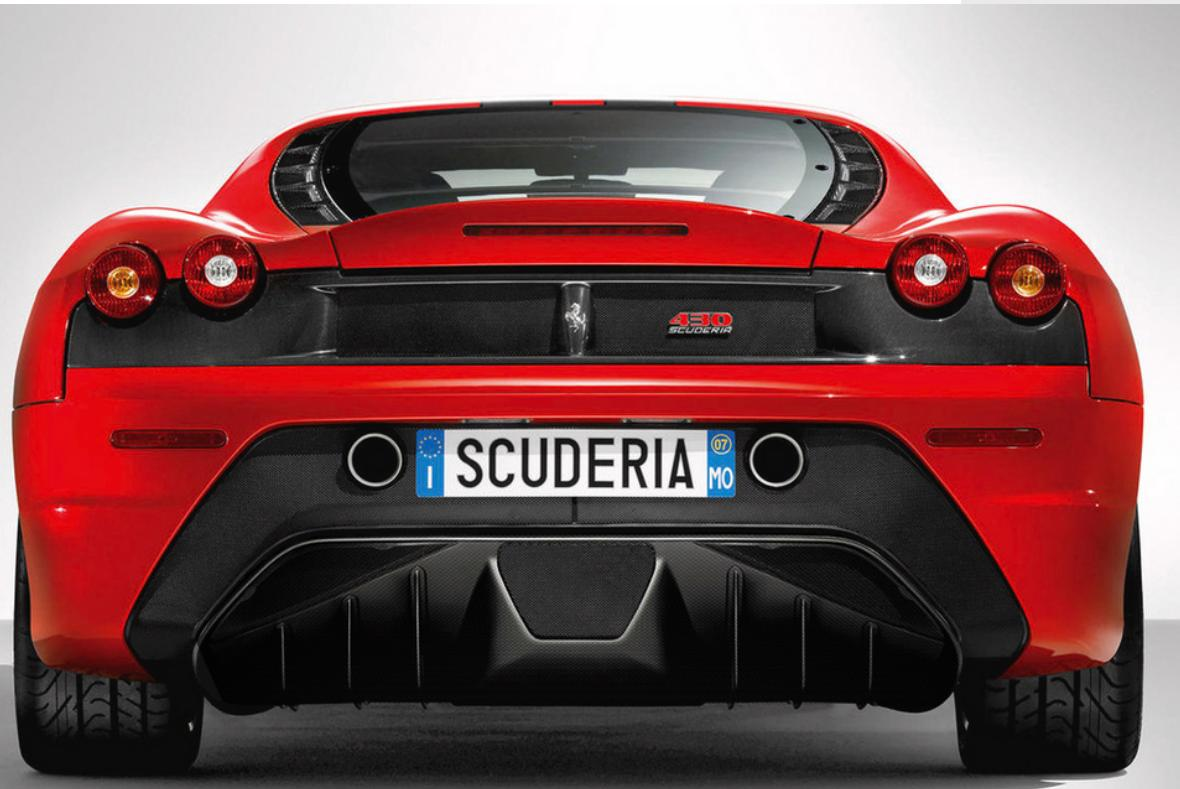
Diseñado para aumentar la carga en la parte trasera y facilitar la extracción de aire de los bajos del bastidor, el difusor de fibra de carbono resalta la estética del vehículo y satisface las exigencias técnicas, contribuyendo a la reducción de peso.
