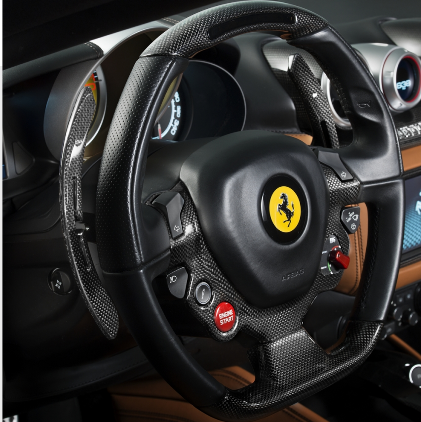
F1 Racing shift paddles, in matte carbon fibre
