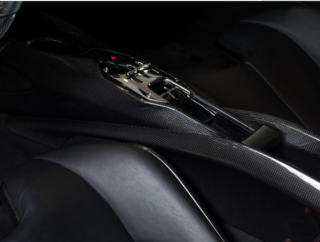
Um der Innenausstattung einen leichten und sportlichen Touch zu verleihen, kann ein Tunnel aus Kohlefaser als Alternative zur im Fahrzeug vorhandenen Variante eingebaut werden.
