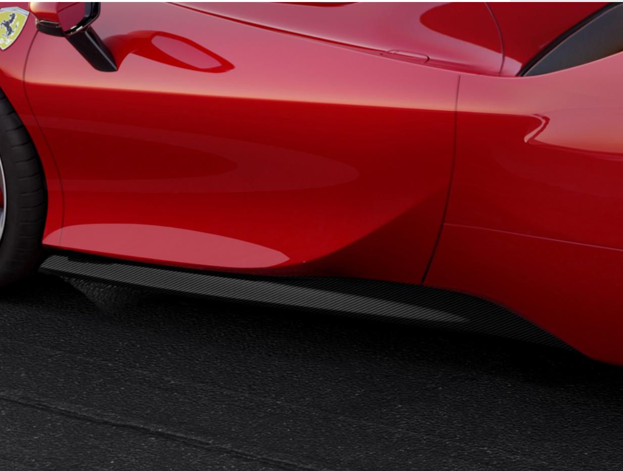
Ferrari Genuine bietet an, die traditionellen Schweller im Fahrzeug durch das Schweller-Kit aus Sicht-Carbon auszutauschen.
