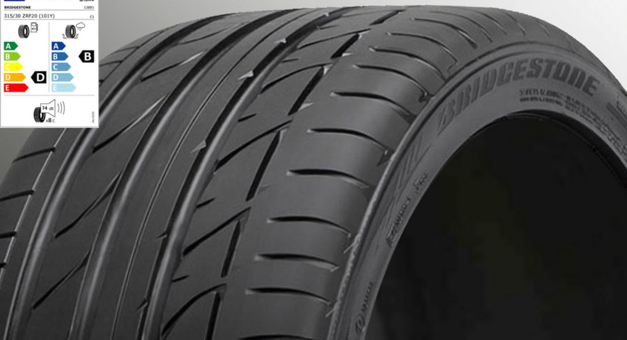
Die Run-Flat-Technologie, die in Zusammenarbeit mit den besten Marken auf dem Markt entwickelt wurde, ermöglicht im Falle einer Reifenpanne eine komfortable und sichere Weiterfahrt des Fahrzeugs für bis zu 80 km bei Geschwindigkeiten von bis zu 80 km/h.
