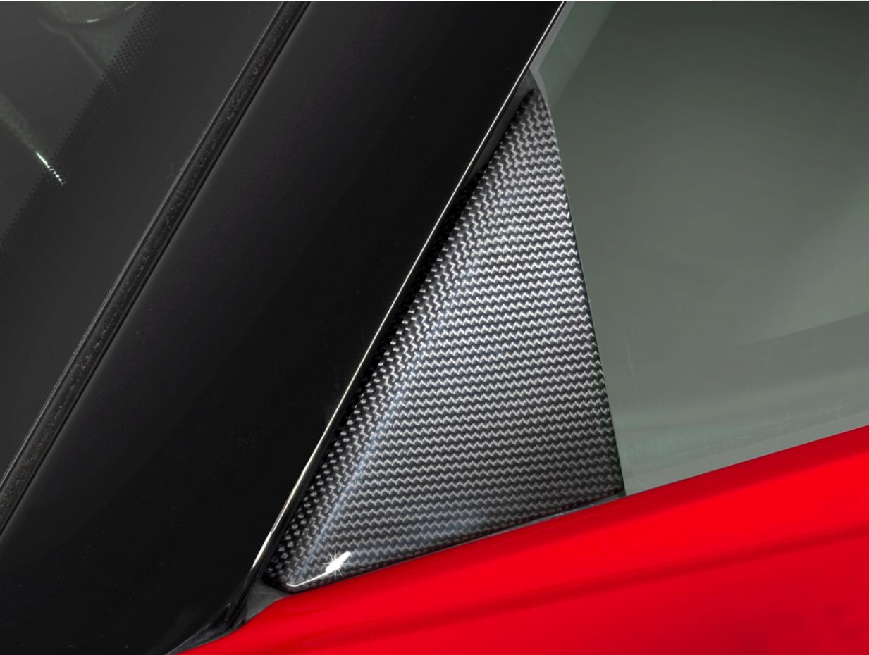
Das Seitenscheiben-Dreieck aus Carbonfaser sorgt für einen Hauch von Exklusivität und trägt aufgrund der Leichtigkeit des Materials dazu bei, das Gesamtgewicht des Fahrzeugs zu reduzieren. Die Carbonfaser unterstreicht außerdem den sportlichen Charakter des Fahrzeugs und stellt eine Wertsteigerung für sein Äußeres dar, wobei der Stil unverwechselbar bleibt
