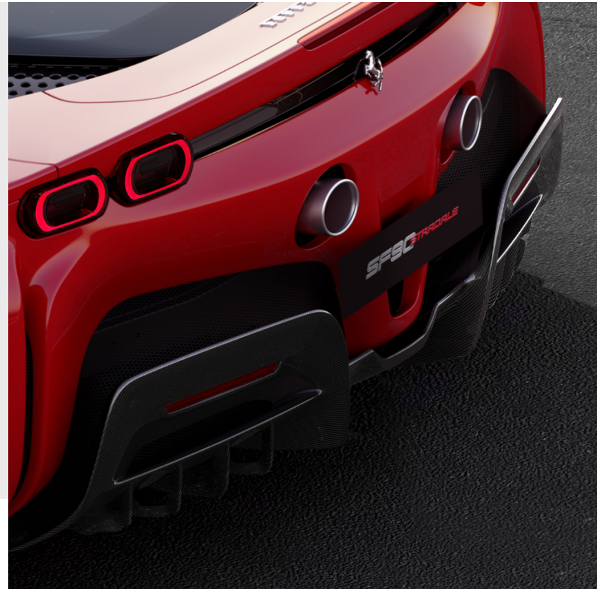
Heckdiffusor aus Kohlefaser, zum Einparken der Kamera
