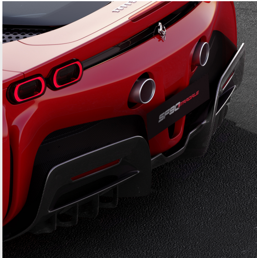
Heckdiffusor aus Kohlefaser, zum Einparken der Kamera
