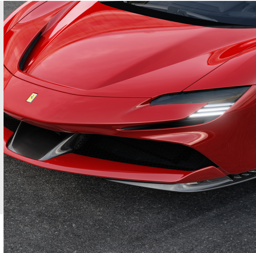
Frontseitige aerodynamische Zusätze aus Kohlefaser
