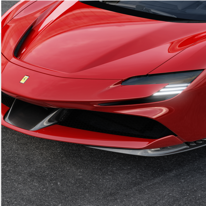
Frontseitige aerodynamische Zusätze aus Kohlefaser
