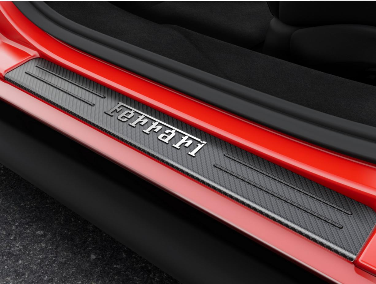
Über das Ferrari Genuine Programm kann die Einstiegsleiste aus Aluminium durch eine Variante gänzlich aus Kohlefaser ersetzt werden. Die Einstiegsleiste wird durch das Ferrari-Logo aus Stahl veredelt.
