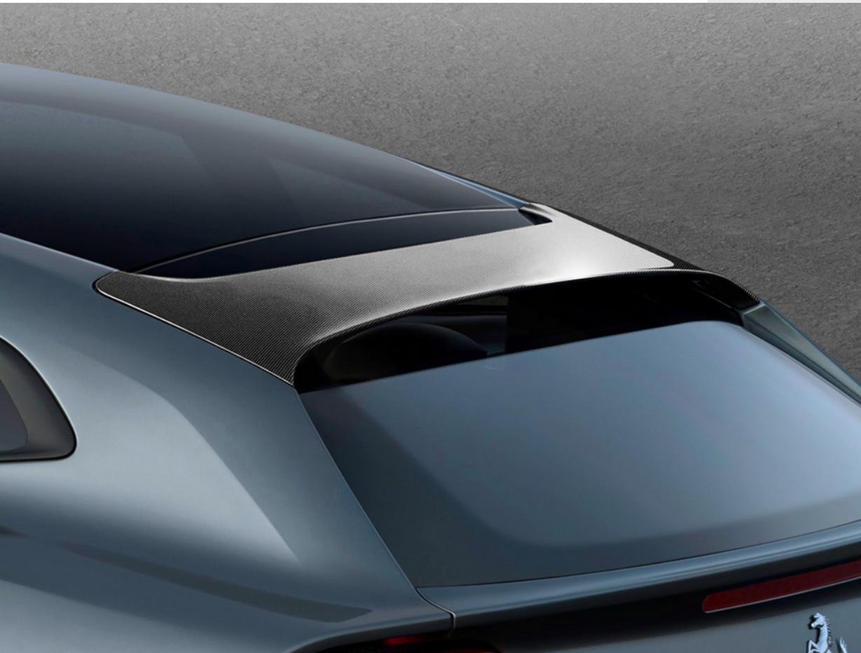
Der Heckspoiler aus Kohlefaser im Katalog Ferrari Genuine ermöglicht die individuelle Gestaltung des Fahrzeugs mit exklusivem Touch und trägt gleichzeitig zur Reduktion des Gesamtgewichts bei.
