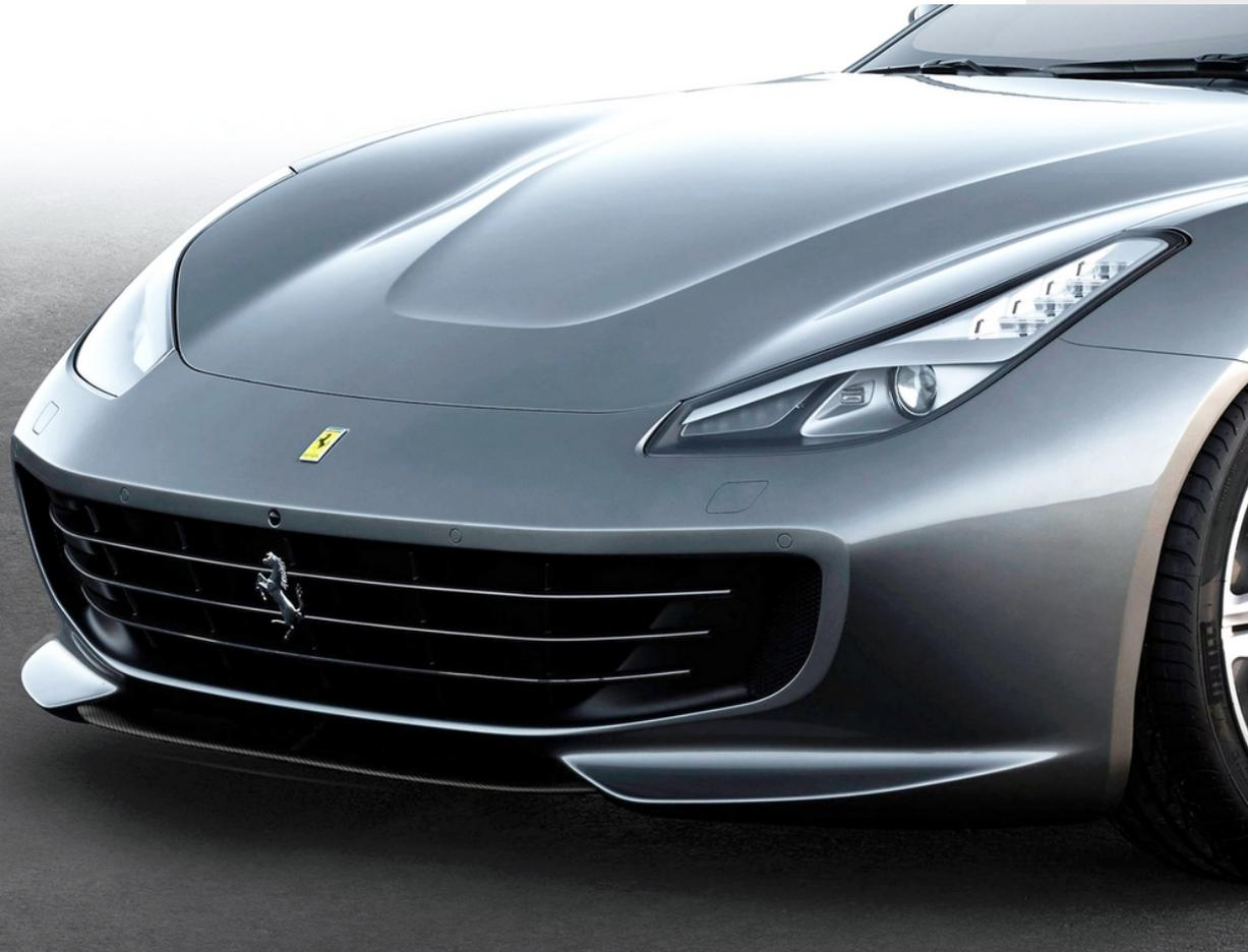
Der mit den innovativsten Techniken der Strömungsdynamik hergestellte und zur Optimierung der Leistungen des Unterbodens im Windkanal getestete Frontspoiler aus Kohlefaser ist ein äußerst wichtiges Element, um das Design des Fahrzeugs zu personalisieren und seine Aerodynamik zu gewährleisten.
