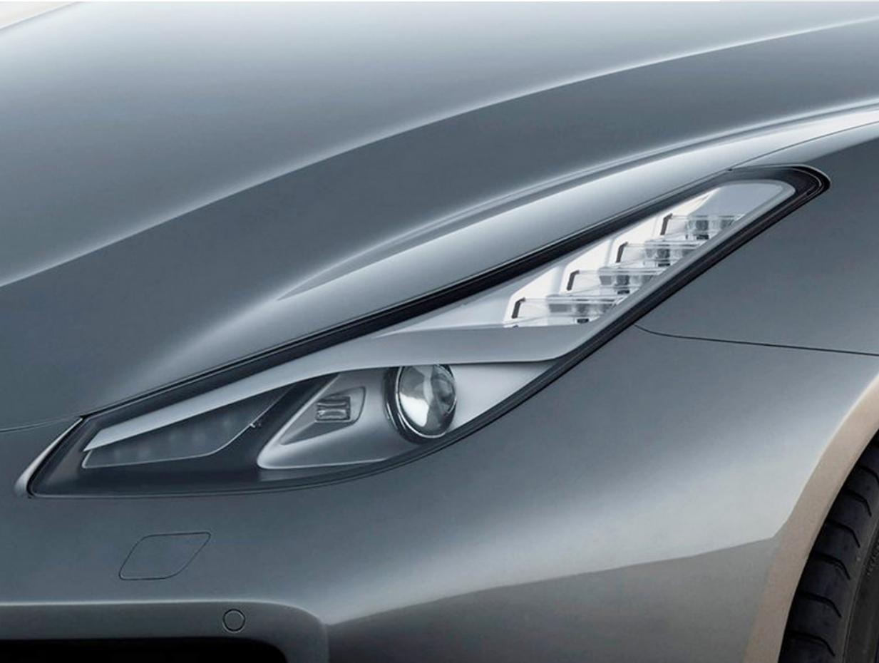
Um eine besseres Fahrerlebnis was Sicherheit und Leistungen betrifft zu garantieren, bietet der Zubehörkatalog Genuine die Installation der AFS-Scheinwerfer - Advanced Frontlighting System - an, die den Lichtstrahl je nach Richtung der Kurve ausrichten, damit die Intensität der Beleuchtung optimieren und eine bessere Sicht gewährleisten.
