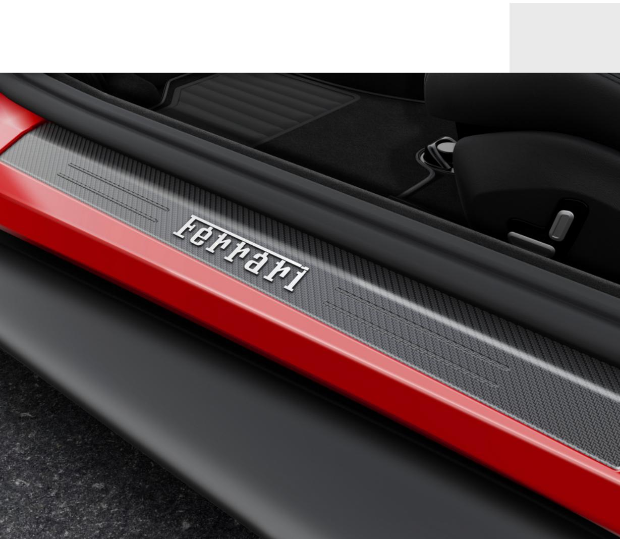
Über das Ferrari Genuine Programm kann die Einstiegsleiste aus Aluminium durch eine Variante gänzlich aus Kohlefaser ersetzt werden. Die Einstiegsleiste wird durch das Ferrari-Logo aus Stahl veredelt.
