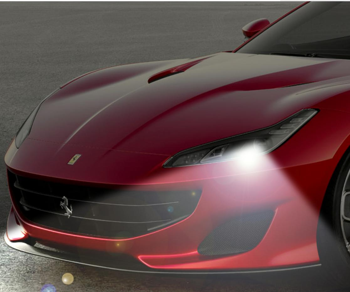
Um eine besseres Fahrerlebnis was Sicherheit und Leistungen betrifft zu garantieren, bietet der Zubehörkatalog Genuine die Installation der AFS-Scheinwerfer - Advanced Frontlighting System - an, die den Lichtstrahl je nach Richtung der Kurve ausrichten, damit die Intensität der Beleuchtung optimieren und eine bessere Sicht gewährleisten.
