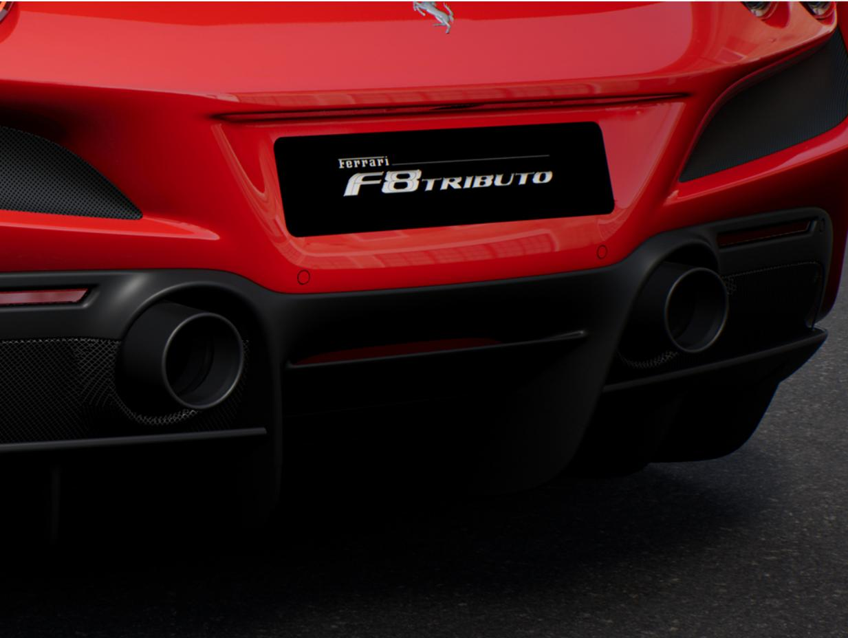
Die Auspuffblenden aus Stahl mit Keramikverkleidung zeichnen sich durch die Verwendung hochentwickelter Materialien und spezifische Oberflächenbehandlungen aus, wodurch das Fahrzeug ein energischeres und sportlicheres Aussehen erhält. Die Keramikverkleidung ermöglicht es, große Mengen Wärme zu zerstreuen, möglichen versehentlichen Beschädigungen zu widerstehen und, dank der speziellen Technologie, ihre Ästhetik über die Zeit hinweg unverändert beizubehalten.
