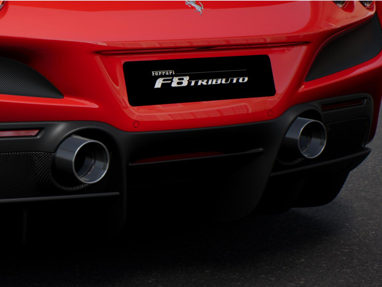
Die auf der gleichen Stilgrundlage der serienmäßigen Endrohre entwickelten Auspuffblenden aus Titan zeichnen sich durch eine Gewichtsreduzierung um 50% und ein Oberflächenfinish aus, das dazu beiträgt, ihre Ästhetik unverändert zu erhalten. Der Einsatz dieses technologisch hoch entwickelten Materials garantiert maximale Beständigkeit gegen äußere Einflüsse, ein weiterer Beweis der ständigen Verbesserung des Produkts durch Ferrari.
