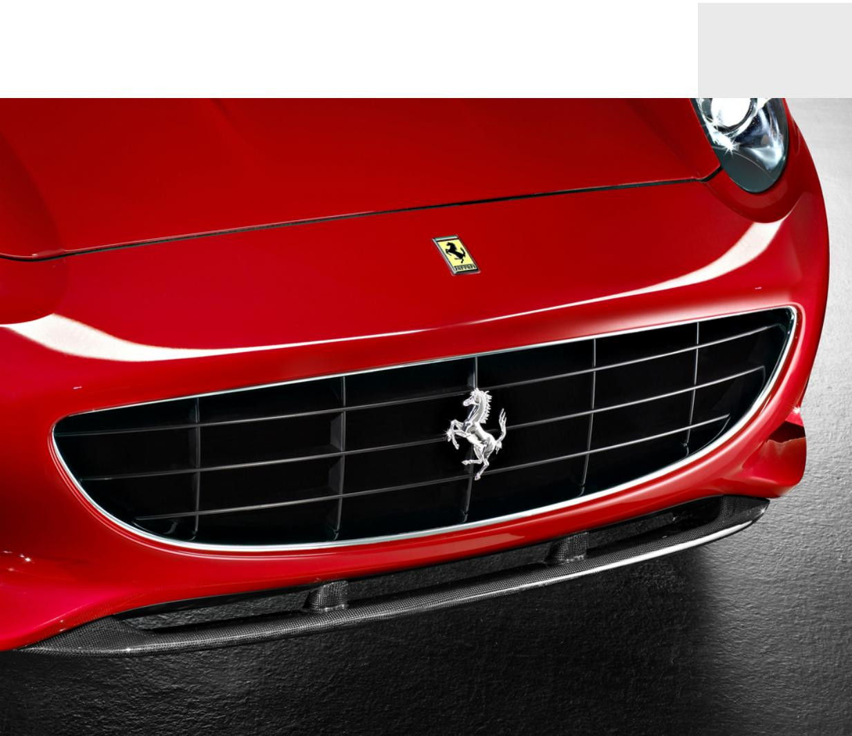
Der mit den innovativsten Techniken der Strömungsdynamik hergestellte und zur Optimierung der Leistungen des Unterbodens im Windkanal getestete Frontspoiler aus Kohlefaser ist ein äußerst wichtiges Element, um das Design des Fahrzeugs zu personalisieren und seine Aerodynamik zu gewährleisten.
