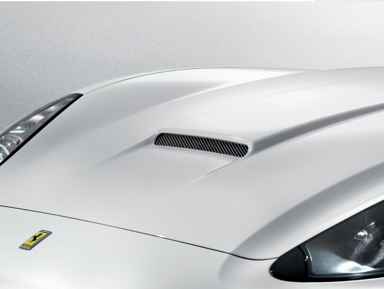
Die Einfassung des Haubengitters ist aus Carbon hergestellt: Dadurch wird diese Komponente leichter und das Auto erhält einen neuen Look, denn es wirkt extrem sportlich und technisch.
