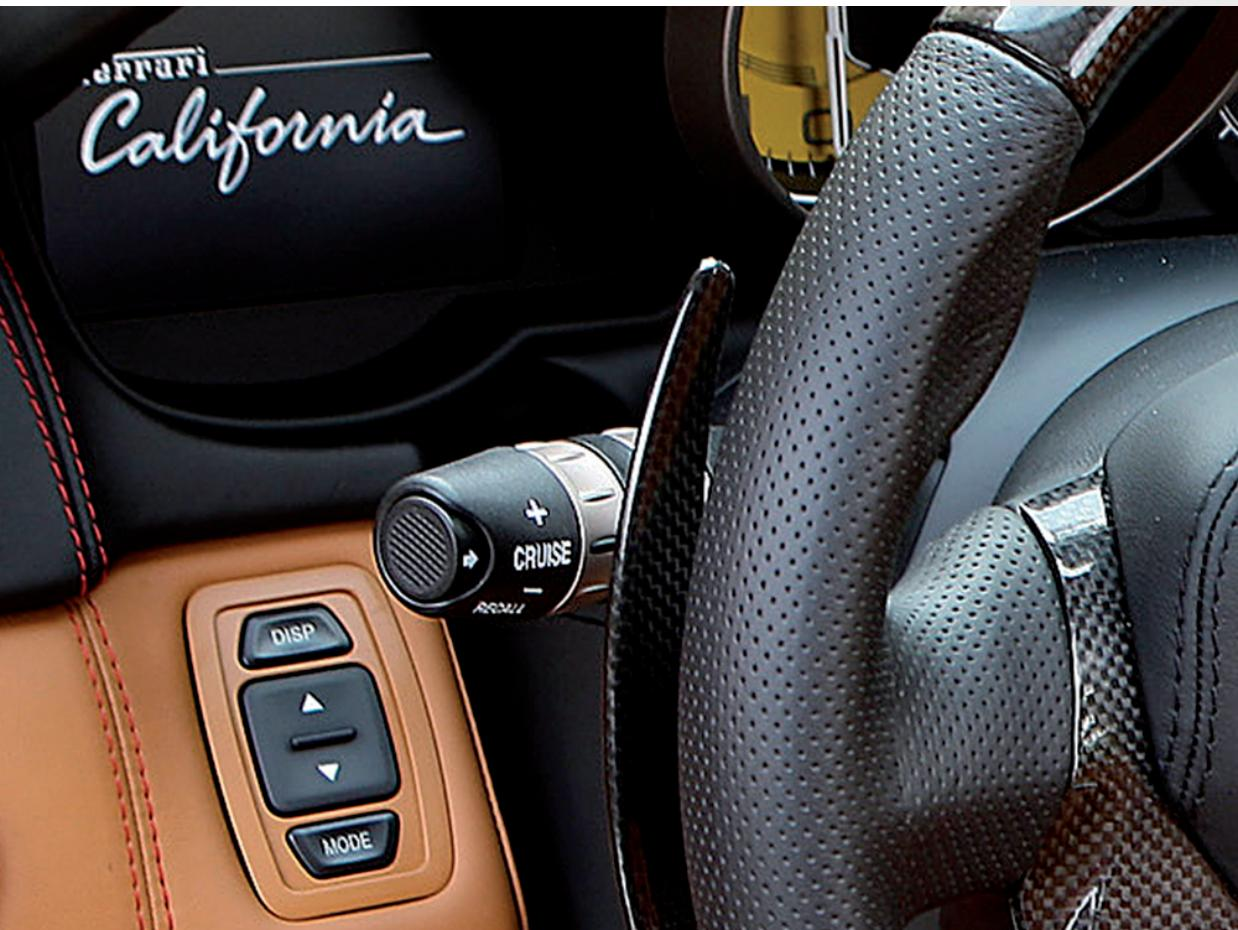
Die Cruise Control ist ein elektronisch gesteuertes Fahrassistenzsystem, das ein Fahren bei konstanter Geschwindigkeit auf langen Autobahnstrecken ermöglicht.
