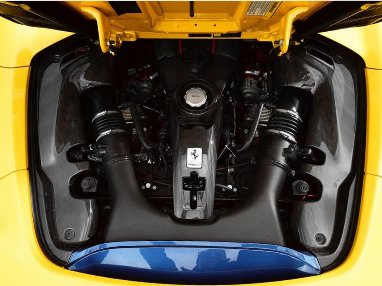
Die Schutzwände aus Kohlefaser ermöglichen eine Gewichtsverringerung im Vergleich zu den serienmäßigen Teilen: Die Kohlefaser ist ein ultraleichtes, hitzebeständiges Material, das über die Zeit unverändert bleibt, dank der technischen und ästhetischen Eigenschaften der Komponente und der transparenten Schutzschicht, mit der sie überzogen ist.
