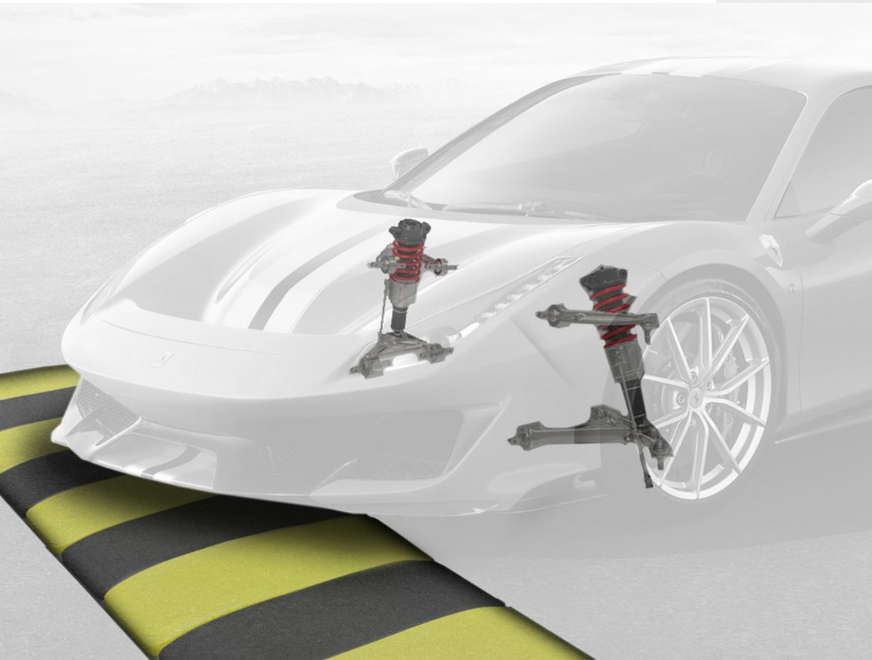
Um maximale Zweckmäßigkeit unter allen Fahrbedingungen zu gewährleisten, bietet Ferrari Genuine ein System an, das das Überfahren von Bodenschwellen oder Rampen erleichtert und die Unversehrtheit des Fahrzeugs wahrt. Der Anheber, der auf die Stoßdämpfer des Fahrzeugs wirkt, ermöglicht es, dieses um ca. 40 mm anzuheben.
