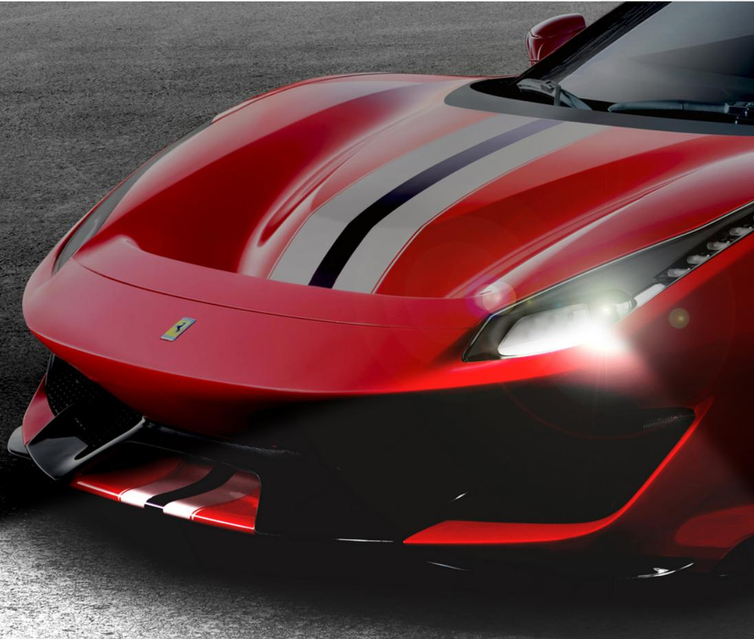
Um eine besseres Fahrerlebnis was Sicherheit und Leistungen betrifft zu garantieren, bietet der Zubehörkatalog Genuine die Installation der AFS-Scheinwerfer - Advanced Frontlighting System - an, die den Lichtstrahl je nach Richtung der Kurve ausrichten, damit die Intensität der Beleuchtung optimieren und eine bessere Sicht gewährleisten.
