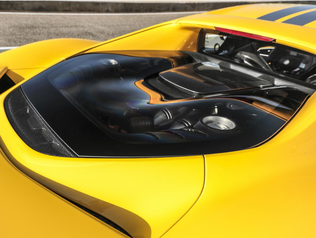
Die Lexan-Heckscheibe reduziert das Gewicht des Autos um weitere 3 kg und macht den Motor besser sichtbar, da er transparenter ist. Diese Option verstärkt definitiv die Rennsport-DNA des Autos.
