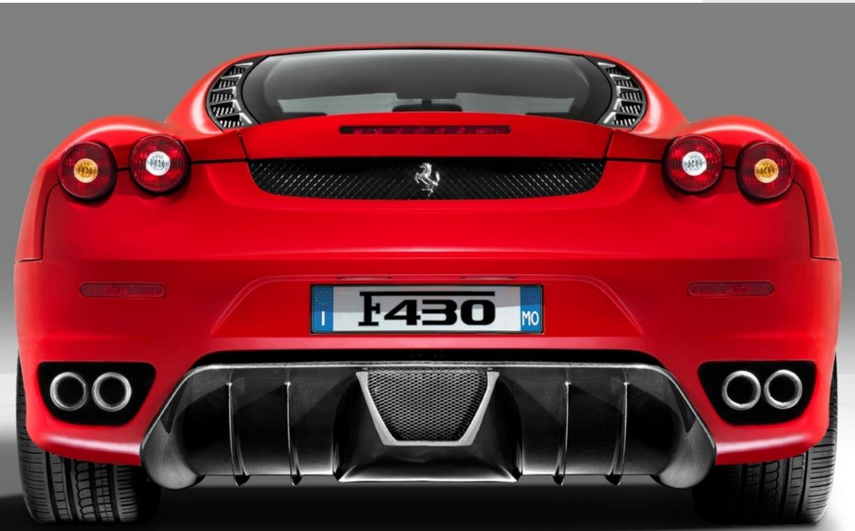
Der Diffusor aus Kohlefaser wurde entwickelt, um den Abtrieb am Heck zu erhöhen und die Entlüftung des Unterbodens zu erleichtern. Gleichzeitig betont er das Fahrzeug-Design und erfüllt die technischen Anforderungen, indem er zur Gewichtsreduzierung beiträgt.
