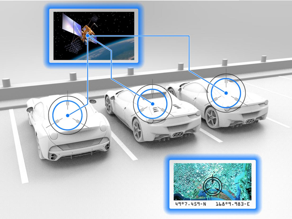
Die Satelliten-Diebstahlsicherung Ferrari Genuine steht in zwei Versionen zur Verfügung, die sich dadurch unterscheiden, ob das System der ADR-Card integriert ist oder nicht. Das System mit ADR-Card erkennt den autorisierten Fahrer durch Aufspüren der persönlichen Card (Automatic Driver Recognition), die dem Kunden zum Zeitpunkt der Kalibrierung der Diebstahlsicherung für das Fahrzeug übergeben wird.
