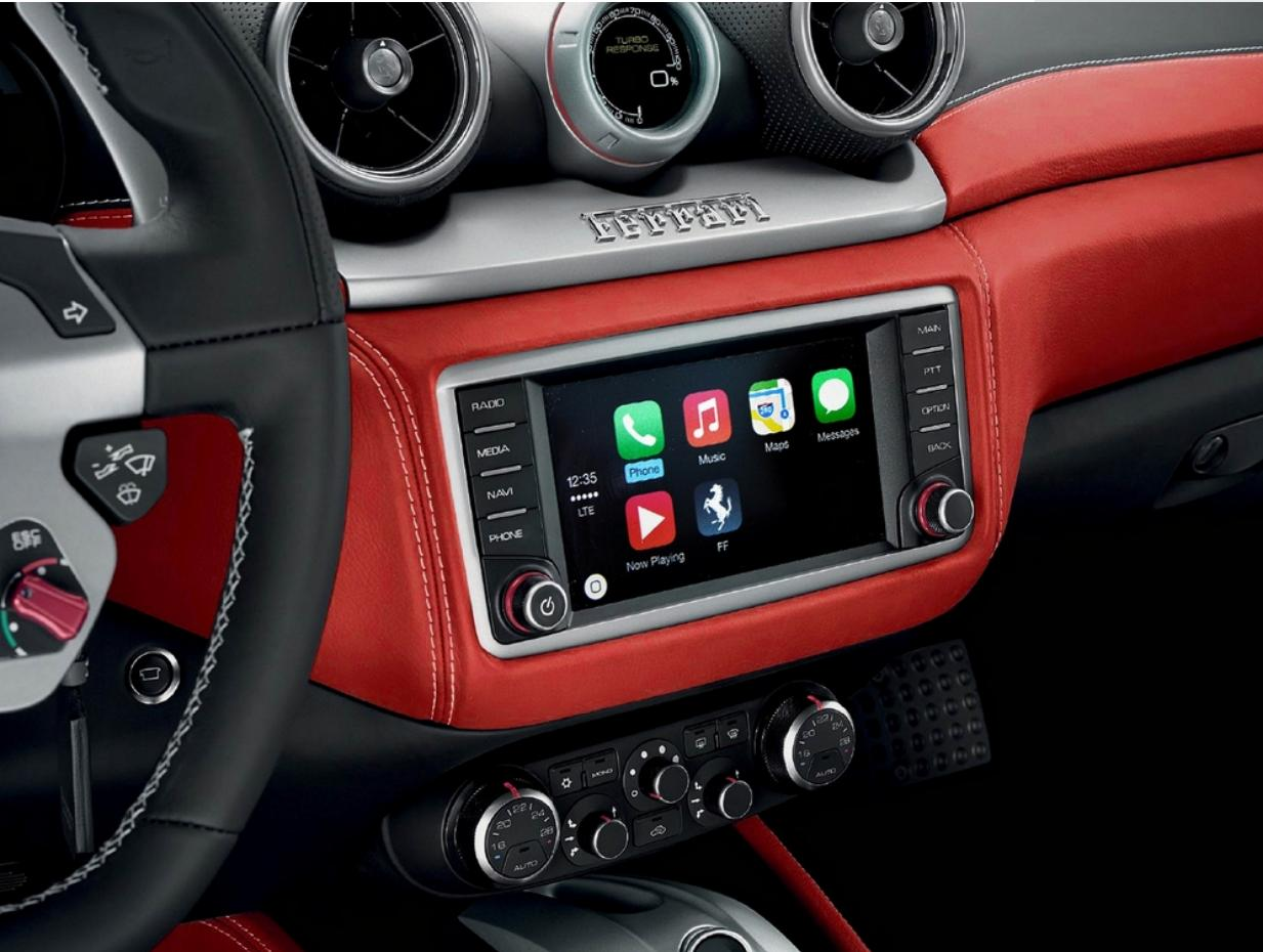
Das Original Ferrari Satelliten-Navigationssystem kann nach dem Verkauf durch Auswechseln des NIT und Anbringen der GPS-Antenne montiert werden.
