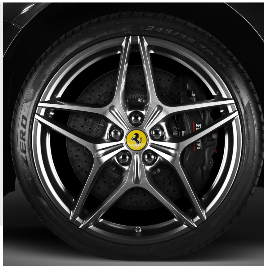
20-Zoll-Schmiedefelgen, zweifarbig diamantpoliert
