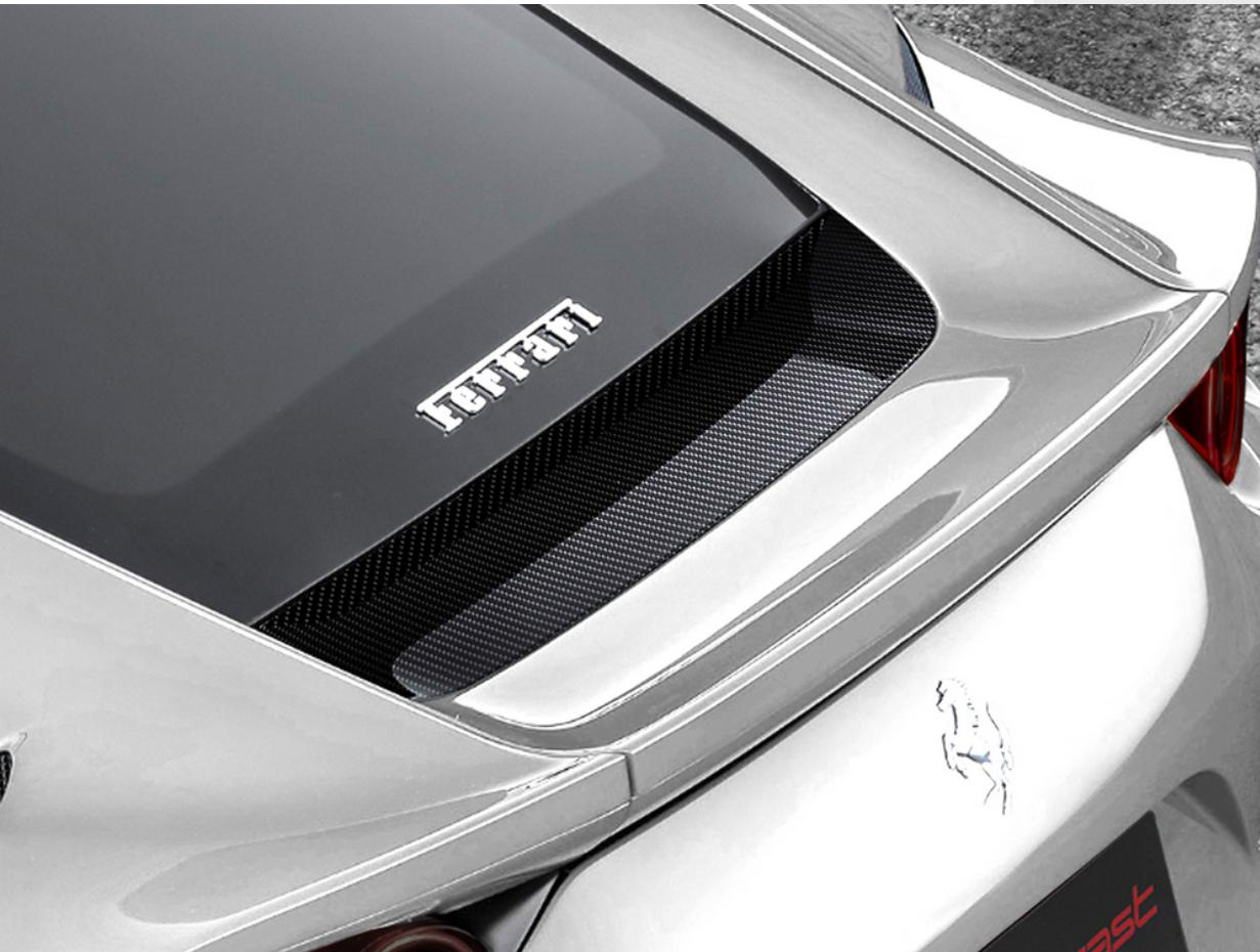
Der heckseitige aerodynamische Kanal am Abschlussteil der Heckscheibe ist ein wesentliches Element für die hintere Aerodynamik des Fahrzeugs.
