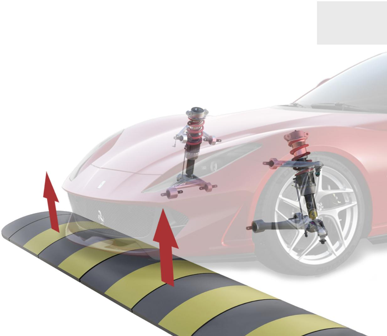
Um maximale Zweckmäßigkeit unter allen Fahrbedingungen zu gewährleisten, bietet Ferrari Genuine ein System an, das das Überfahren von Bodenschwellen oder Rampen erleichtert und die Unversehrtheit des Fahrzeugs wahrt. Der Anheber, der auf die Stoßdämpfer des Fahrzeugs wirkt, ermöglicht es, dieses um ca. 40 mm anzuheben.
