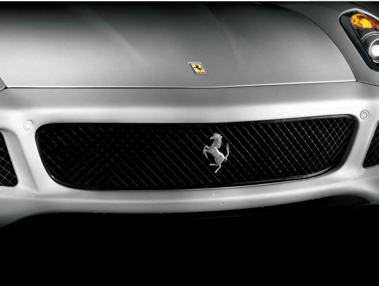
Der Kühlergrill im GTO-Stil ist ein ikonisches Element, das die sportlichsten Fahrzeuge von Maranello gekennzeichnet hat, und ermöglicht es, das Design seines Autos persönlich zu gestalten. Die Verwendung eines Gitters mit Wabenstruktur, das so lackiert und behandelt ist, dass es die ästhetischen Qualitätsstandards der Ferrari-Fahrzeuge im Laufe der Zeit gewährleistet, garantiert Leichtigkeit und Sportlichkeit.
