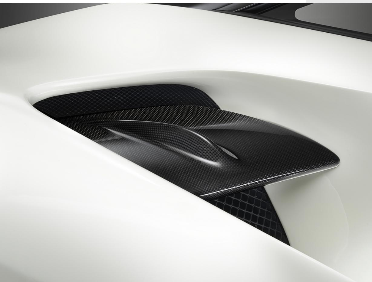
Die in die seitlichen Lufteinlässe eingebauten Splitter sind ikonische Elemente, die die sportlichen Linien des Autos charakterisieren und die Luftströme trennen, um maximale Motorleistung zu gewährleisten.
