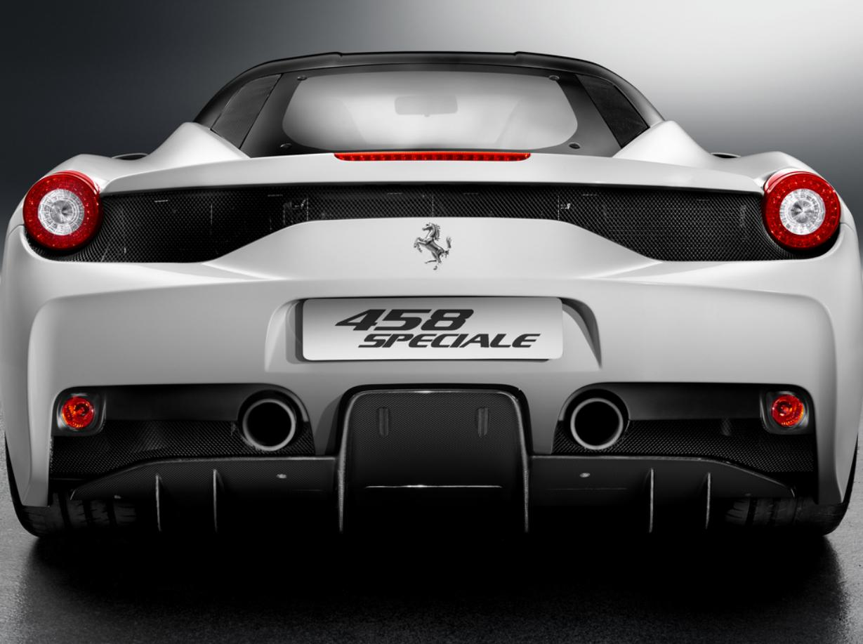
Die aerodynamischen Leitbleche aus Kohlefaser sind eine Lösung mit starker ästhetischer Wirkung, die dazu beiträgt, das Gesamtgewicht des Fahrzeugs zu verringern.
