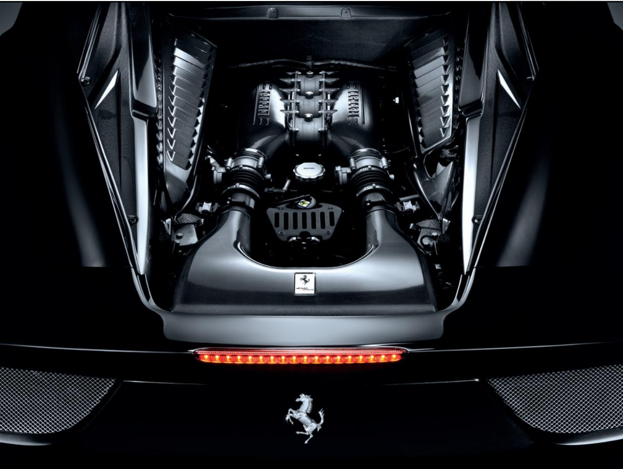
Eine der grundlegenden technischen Komponenten für die Motorleistung ist die Airbox oder Luftansaugkammer, deren Eigenschaften, wie Volumen, Form, Länge der Ansaugtrichter, Abmessungen und Rauheit der Oberflächen, zur Maximierung der Leistung beitragen und dem Motor das Ansaugen der jeweils benötigten Luft ermöglichen.
