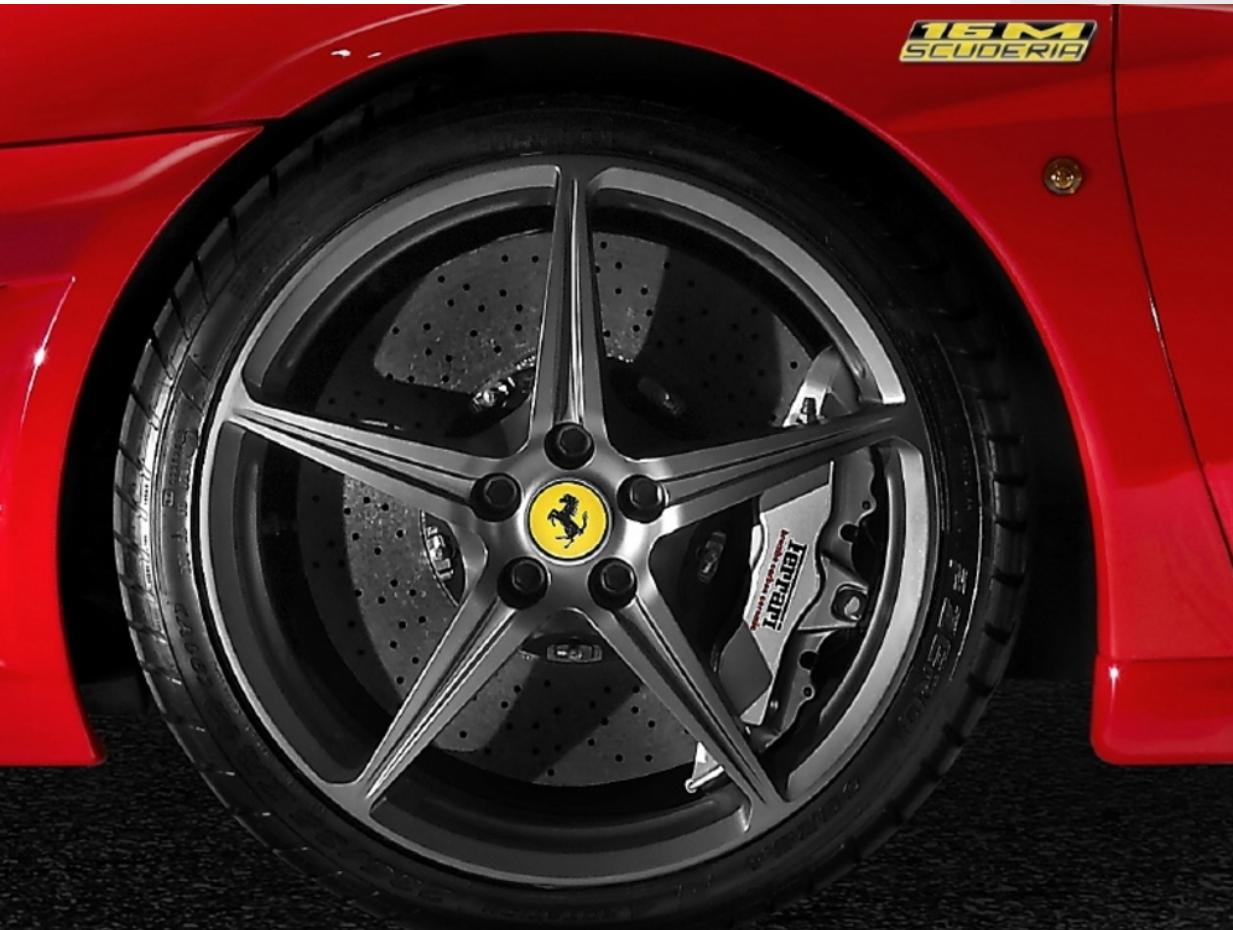
Der Einsatz von Schmiedefelgen im Vergleich zu Standardfelgen gestattet eine Gewichtsreduzierung um 11 kg. Die Reduzierung der nicht aufgehängten Massen sorgt für einen direkteren Kontakt zum Fahrzeug, wodurch Kunden, die eine aggressiveren und anspruchsvolleren Fahrstil haben, die sportliche Seele ihres Wagens voll auskosten können.
